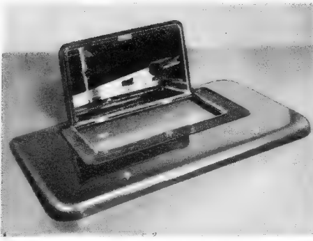
Bild 3. Kofferdeckel mit aufgeklapptem Spiegel zum Beobachten des Schirmbildes von der Rückseite des Empfängers aus
