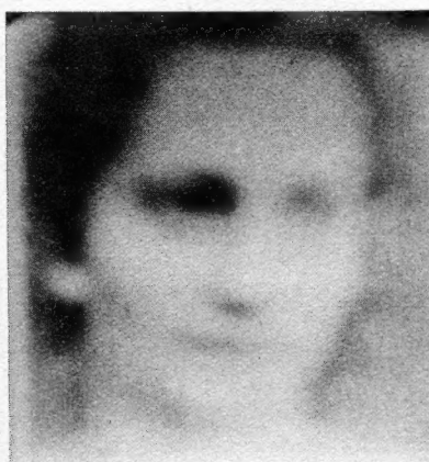
Bild 216. Unrichtige Einstellung des Fokussierstromes
