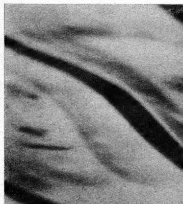
Bild 214. Falsche Zeilenfrequenz und falsche Synchronisierphase
